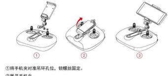
1. 将手机夹对准穿孔孔, 锁螺丝固定。
