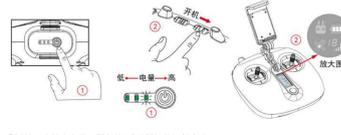
1. 短按一次检查电量, 再长按2秒关闭智能飞行电池。
