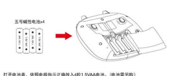
打开电池盖, 依照电极指示正确放入4节1.5VAAA电池。(电池需旁购)
