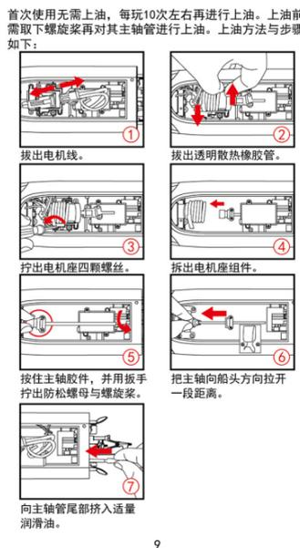
首次使用无需上油，每玩10次左右再进行上油。上油前需取下螺旋桨再对其主轴管进行上油。上油方法与步骤如下：
