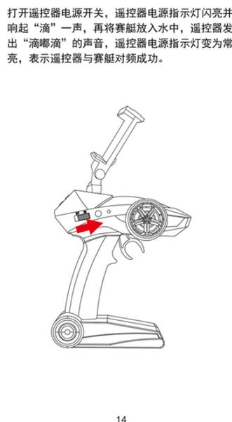
打开遥控器电源开关，遥控器电源指示灯闪亮并响起“滴”一声，再将赛艇放入水中，遥控器发出“滴滴滴”的声音，遥控器电源指示灯变为常亮，表示遥控器与赛艇对频成功。
