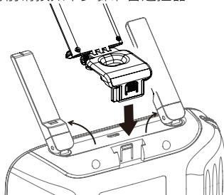
1) 如图所示，向外侧展开天线，将手机支架装在遥控器背面的卡槽内；
