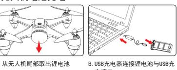
A. 从无人机尾部取出锂电池 B. USB充电器连接锂电池与USB充电接口
