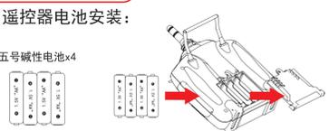
打开电池盖，依照电极指示正确放入4粒1.5V AA电池。(电池需另购)
