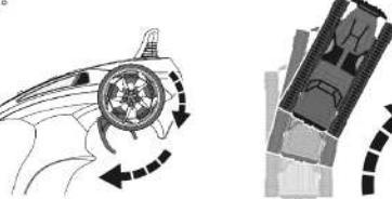
5. 将油门扳机向前推，同时左转转向轮，坦克车左转后退。
