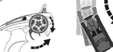
7. 向左转动转向轮，坦克车向左方向原地360°旋转。
