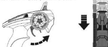
3. 将油门扳机向后拉，同时左转转向轮，坦克车左转前进。
