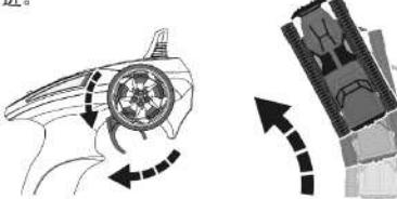
4. 将油门扳机向后拉，同时右转转向轮，坦克车右转前进。
