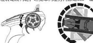
8. 向右转动转向轮，坦克车向右方向原地360°旋转。
